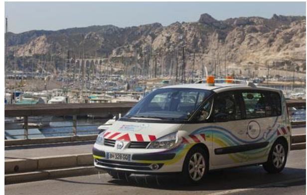
À vitesse réduite les « **barbiches** », des capteurs de méthane 10 000 fois plus sensibles que le nez humain, recueillent les informations qui s'affichent sur l'ordinateur du technicien à l'arrière du véhicule. En cas de présence suspecte de méthane, le technicien procède à des analyses complémentaires et fait appel au besoin à une équipe d'intervention.
