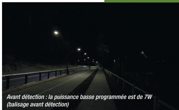
Avant détection : la puissance basse programmée est de 7W (balisage avant détection)
